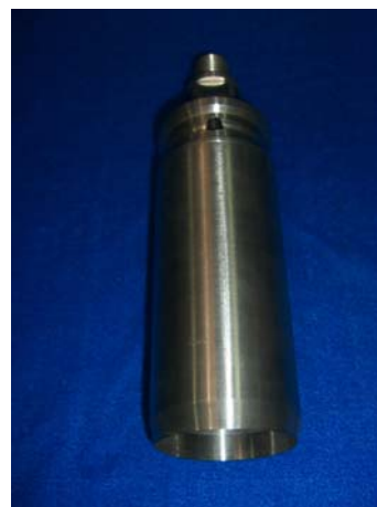
深层环刀固定器组装后效果
