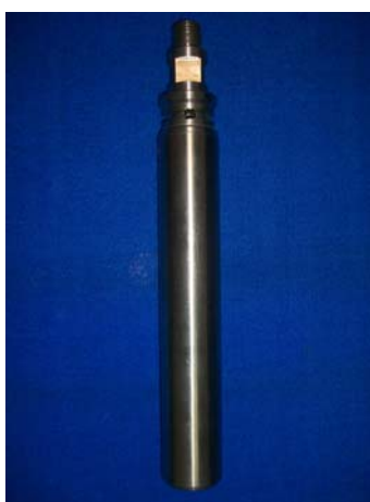
土壤有机物分析采样器（安装后）
